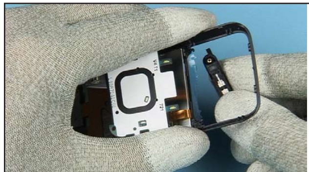
22. Insert the NAVI SLIDER...
