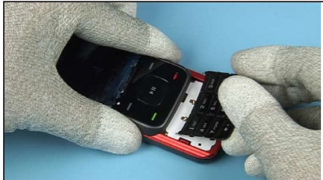
58. Insert the NUMERIC KEYMAT.
